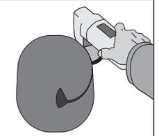
Dévisser les boutons jusqu'à leur butée et introduire la trappe de biais dans l'ouverture : la paroi de la gaine est alors intercalée entre les couvercles. Centrer la trappe et serrer les boutons.
